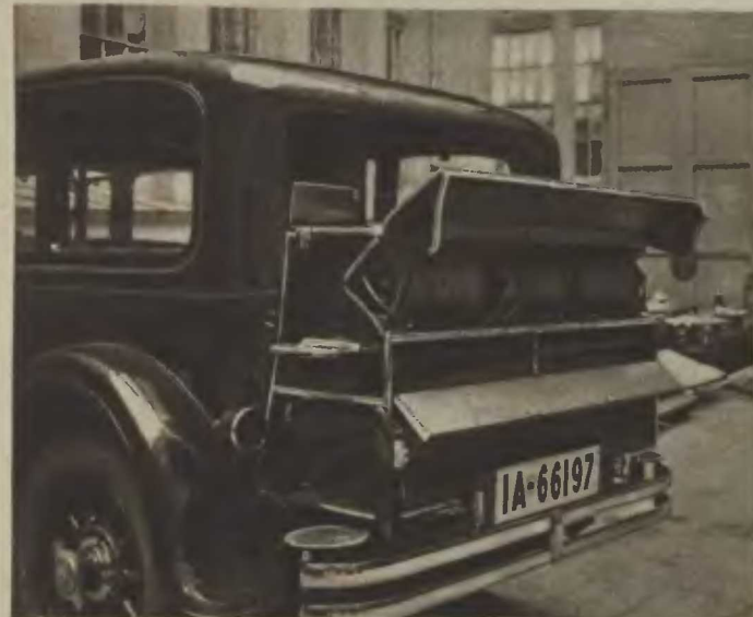
Rückansicht des Wagens mit Batterie-Koffer und Kabeltrommel für Mikrophon
