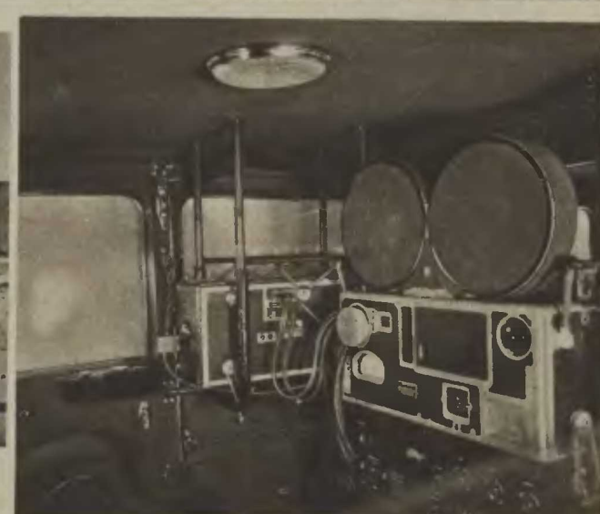
Blick in das Innere des Wagens. Ganz links Eis für den Aufnahme-Apparat, davor der Verstärkerkasten, darunter Verteilertasten und Kontroll-Einrichtung
