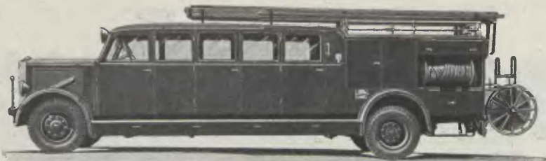
Fischer Automobilspritzen, Leistung 1500 und 2500 Liter pro Minute Fischer automobile Mannschaftswagen
