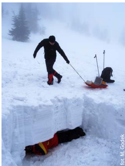
Georadarowe badania pokrywy śnieżnej
